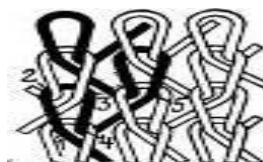
Рисунок 14 – Схема основовязного трикотажа
