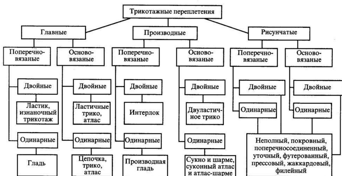
Рисунок 11 – Схема классификации трикотажных переплетений
