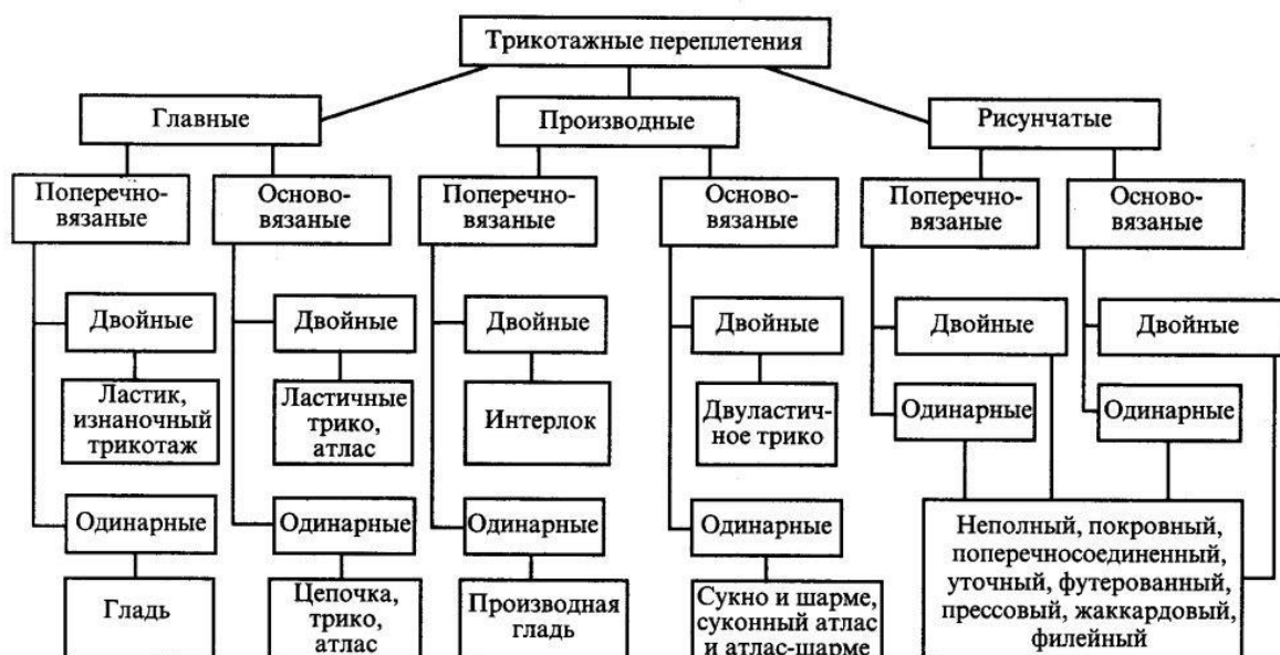
Рисунок 6 – Схема классификации трикотажных переплетений
