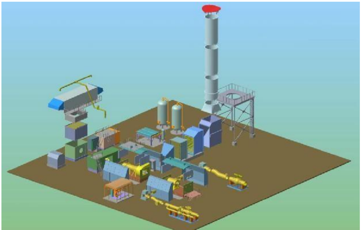
Рис.3.5. Монтажные блоки ГПА–16 “Волга”
