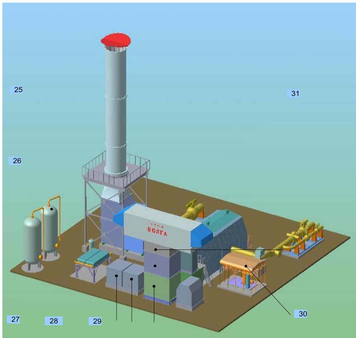
Рис.2.5.Компоновка ГПА “Волга”
