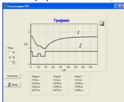
Рис. 9. Экспериментальная зависимость переходного тока I от времени t (1), полученная на экране ЦО при интродиагностике РПН, и результат ее обработки (2) с применением специальной встроенной компьютерной программы.
