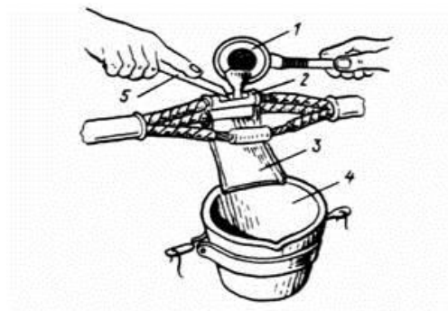
Рис. 6.8. Соединение жил пайки поливом расплавленного припоя:
