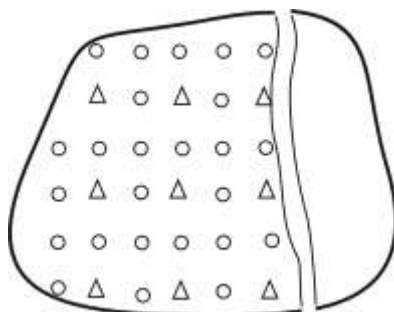
Рис. 3.13. Девятиточечная система внутриконтурного заводнения
