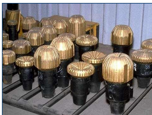
Рис. 3.20. Алмазное долото: 1 – корпус; 2 – матрица; 3 – алмазные зерна
