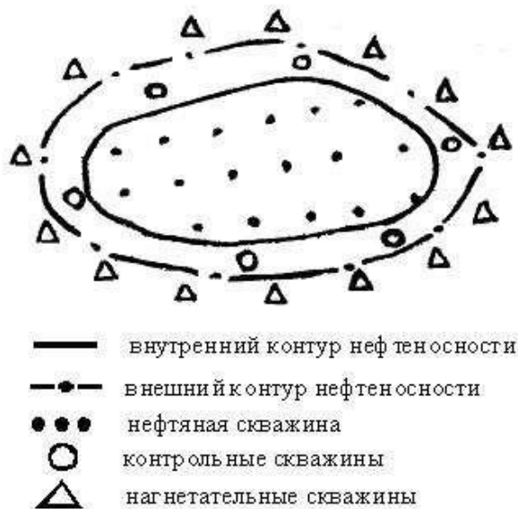
Рис. 5.2. Схема законтурного заводнения
