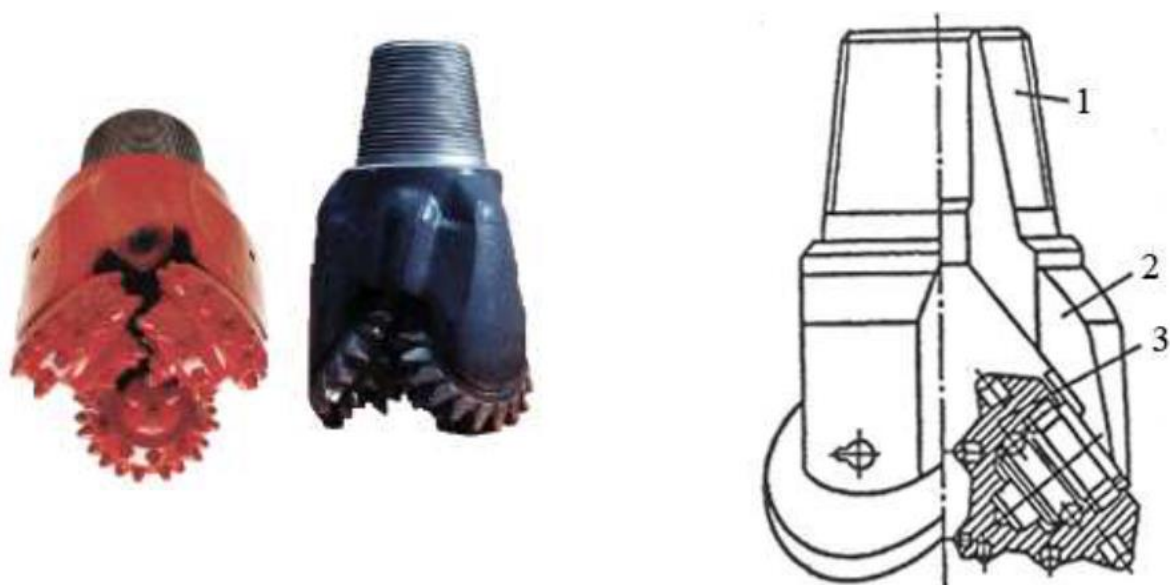
Рис. 3.19. Шарошечное долото: 1 – корпус с резьбовой головкой; 2 – лапа с опорой; 3 – шарошка
