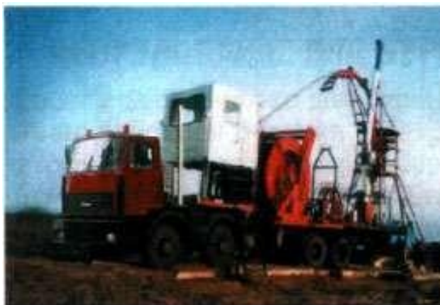
Рис. 3.1. Колтюбинговая установка М20 в рабочем положении
