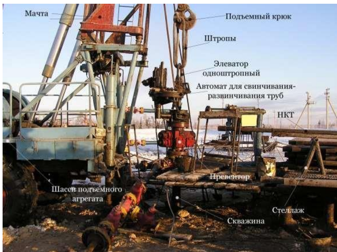
Рис. 12.2. Подъемный агрегат на устье ремонтируемой скважины
