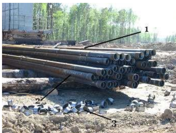
Рис. 3.5. Обсадные трубы, подготавливаемые к спуску в скважину: 1 – обсадные трубы; 2 – маркировка труб; 3 – предохранительные клапаны
