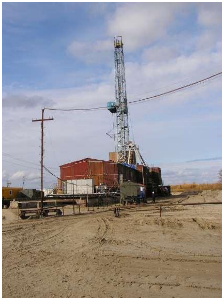
Рис. 3.10. Буровая установка с одноопорной вышкой мачтового типа
