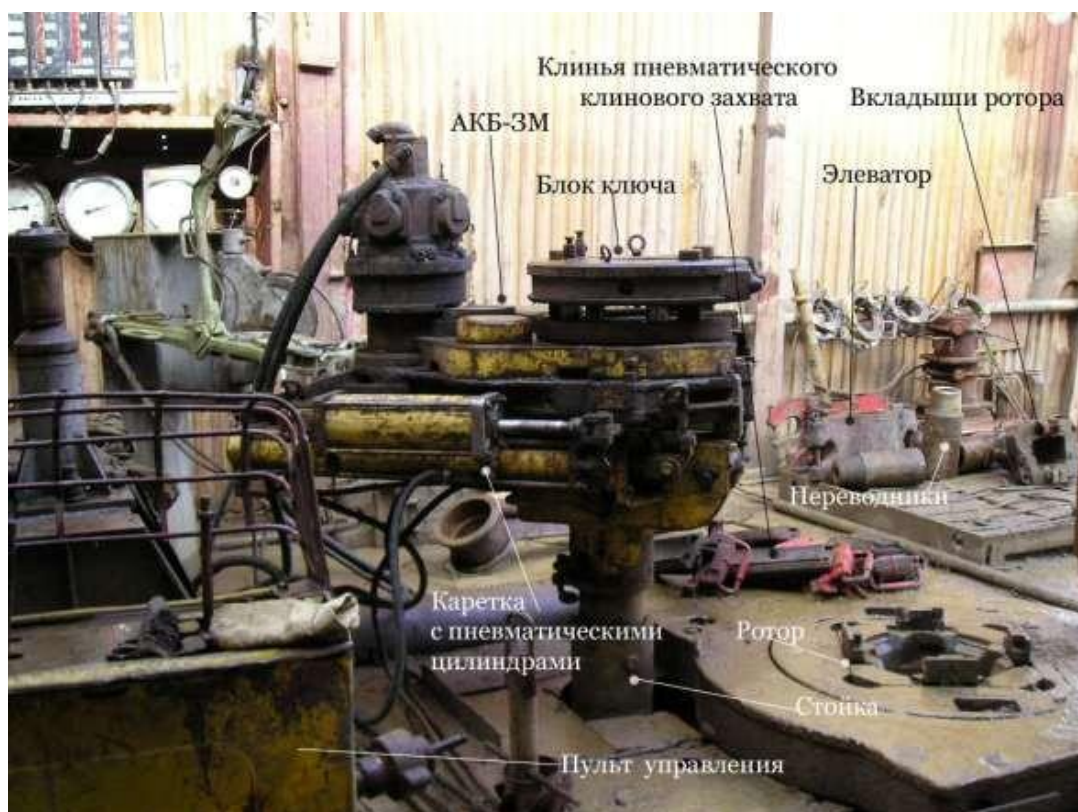
Рис. 3.15. Ключ буровой АКБ-3М
