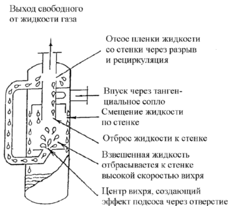
Рисунок 2.3. Рециркуляционный сепаратор фирмы Порта ТЭСТ
