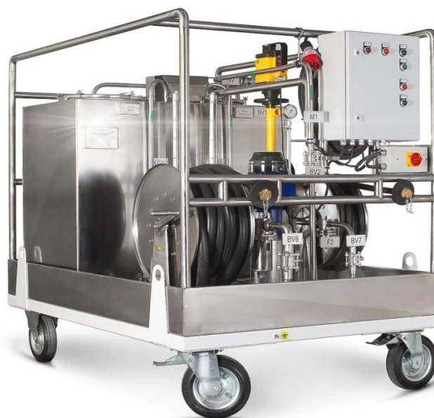
Рис.31. Устройство ТПМ02 для подачи моющего раствора и дистиллированной воды в ОК ГТУ
