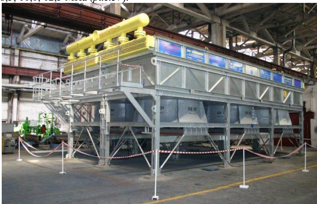
Рис.37 Аппарат воздушного охлаждения типа «Айсберг»
