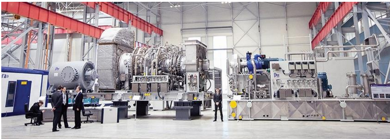
Рис.2. Газоперекачивающий агрегат «Ладоба-32» мощностью 32 МВт – ключевое звено в рамках стратегической программы по реконструкции газопроводной системы России. Производитель – «РЭП Холдинг», г. Санкт-Петербург
