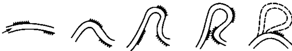
Рис. 31. Схема смещения и изменения формы излучины: 1 - участок размыва берега; 2 – старица
