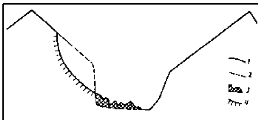
Рисунок 35 – Схематический профиль обвального склона, где: 1 – современный профиль долины; 2 – профиль долины на участке обвала до обвала; 3 – обвальные массы на дне долины; 4 – профиль обвальной ниши
