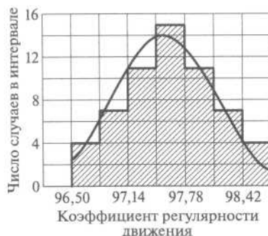
Рис. 2.9 Гистограмма и соответствующая ей теоретическая кривая распределения коэффициента регулярности движения в дифференциальной форме
