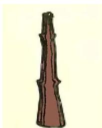
*Сбежистость* - резкое уменьшение диаметра ствола на всем протяжении от комля до вершины, превышающее нормальный сбег, равный 1см на 1м длины бревна. Этот порок увеличивает отходы при распиловке, обуславливает появление радиального наклона волокон в пиломатериале и шпоне, снижение прочности.
