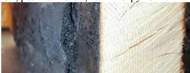
Рис.5.2. Невспучивающийся состав после воздействия огня.
