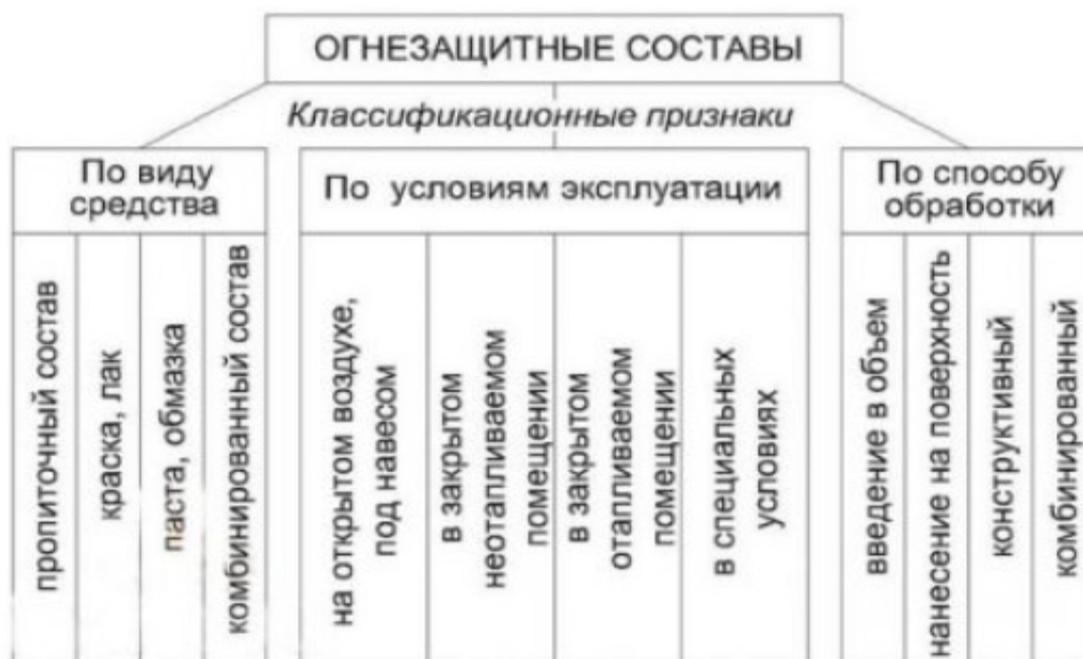
Рис. 5.1. Классификация огнезащитных составов.
