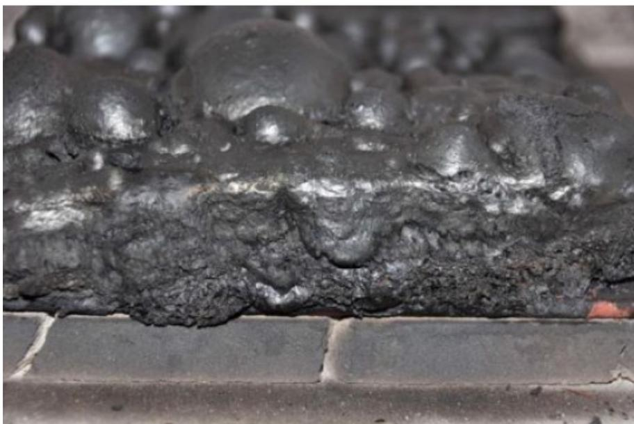
Рис.5.5. Вспучивающийся состав после воздействия огня.
