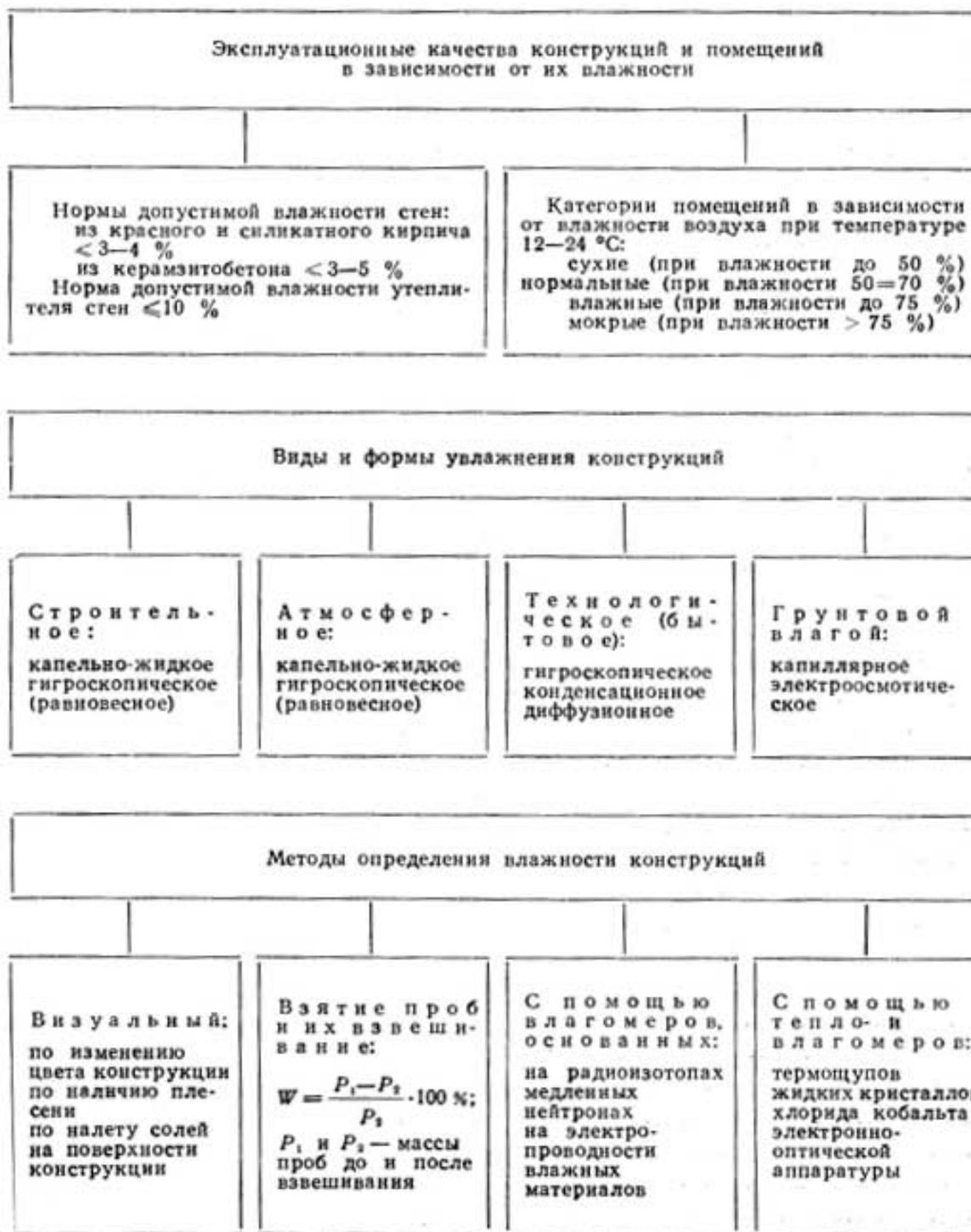
Рис. 2.1. Виды и формы увлажнения конструкций.
