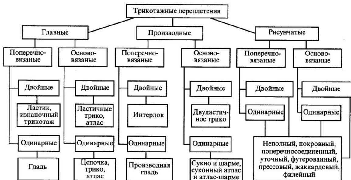
Рисунок 11 – Схема классификации трикотажных переплетений
