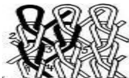
Рисунок 14 – Схема основовязного трикотажа
