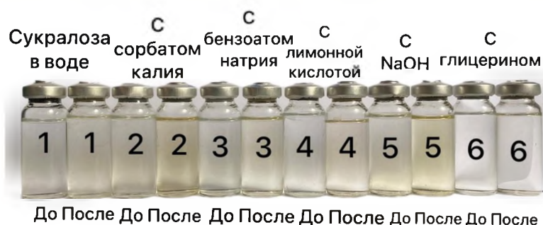
Рис. 2. Внешний вид флаконов до и после 30 дней термостат 45 с раствором 15% сукралозы в воде (1), (2) – с добавлением 0,1% сорбата калия, (3) – 0,1% бензоата натрия, (4) лимонной кислоты до pH = 3,5, (5) 0,1 M NaOH до pH 8,8; (6) раствор 15% сукралозы в смеси глицерин/вода 84/16.
