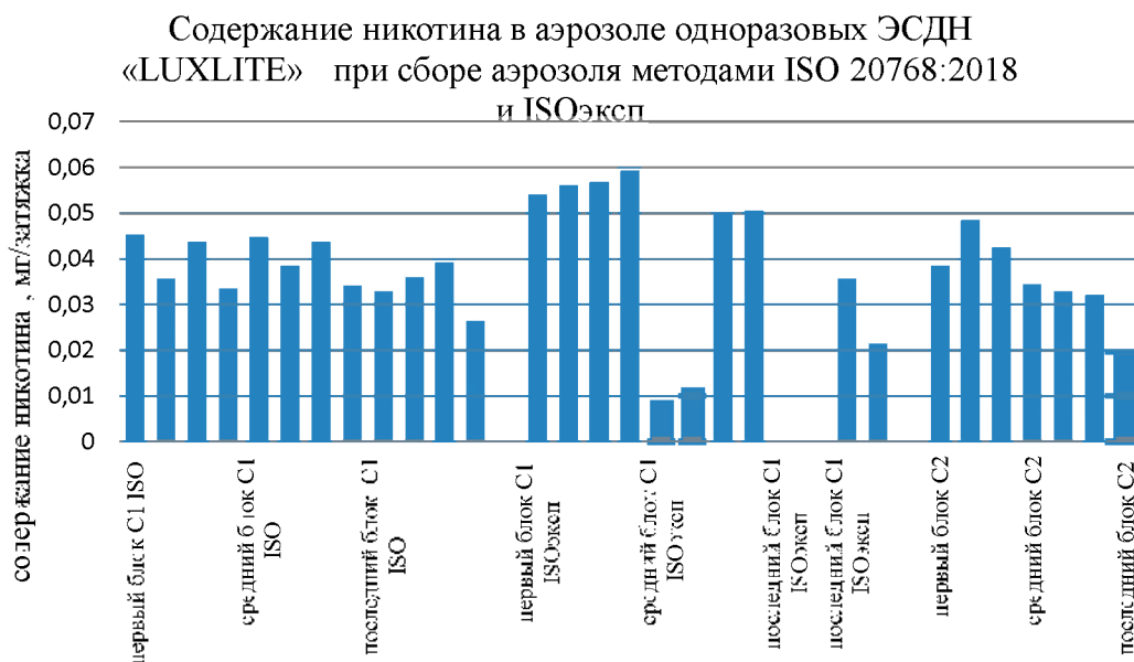
Рис. 4. Содержание никотина в аэрозоле одноразовых ЭСДН «LUXLITE» при сборе аэрозоля по методам ISO 20768:2018 и ISOэксп
