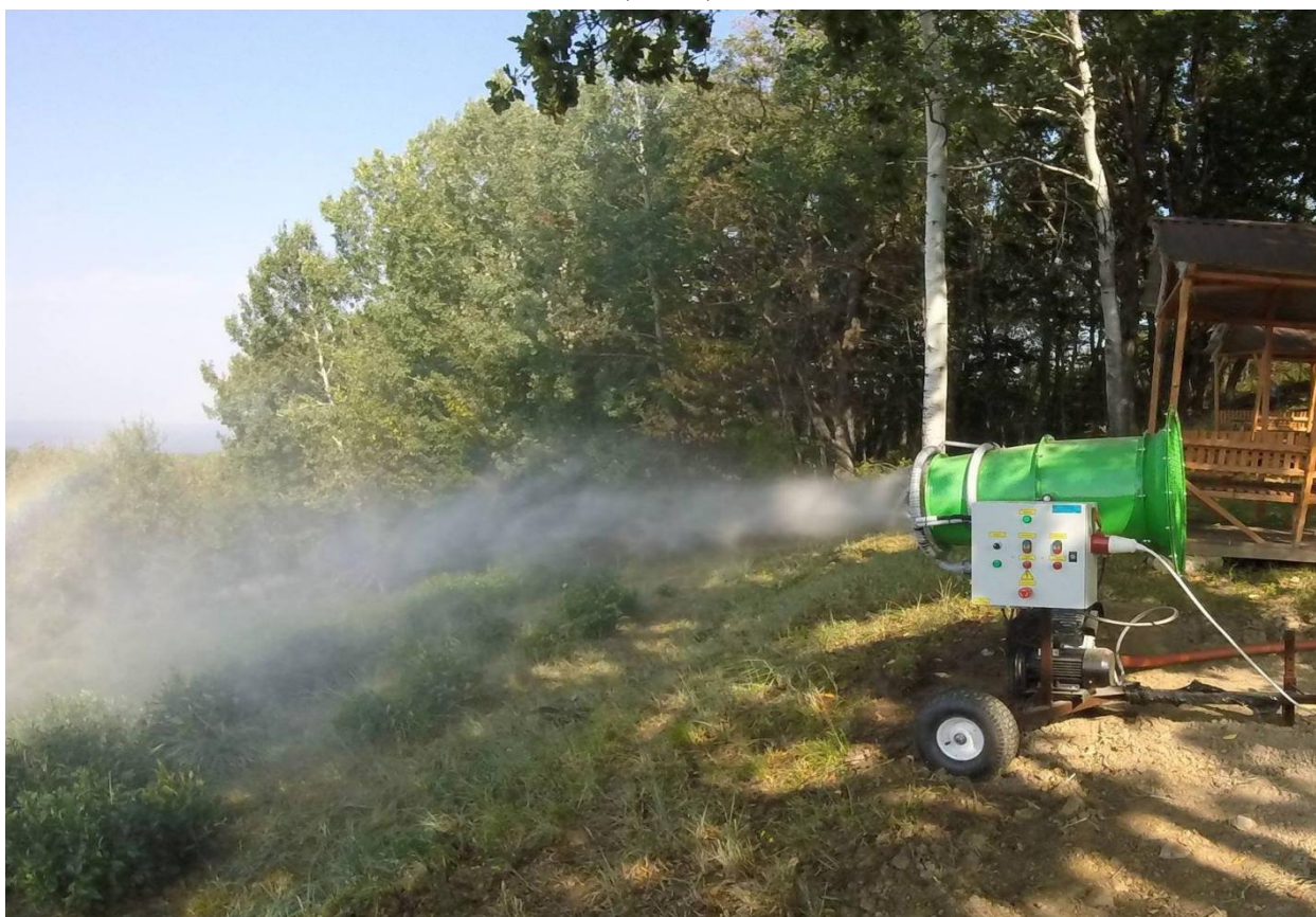
Рис. 1 Снегогенератор (снежная пушка) модель ESG-305
