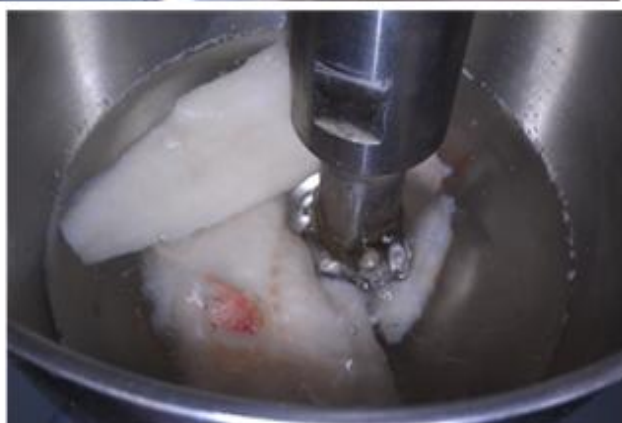
Рис. 4. Экспериментальная установка по размораживанию филе рыб в поле ультразвука
