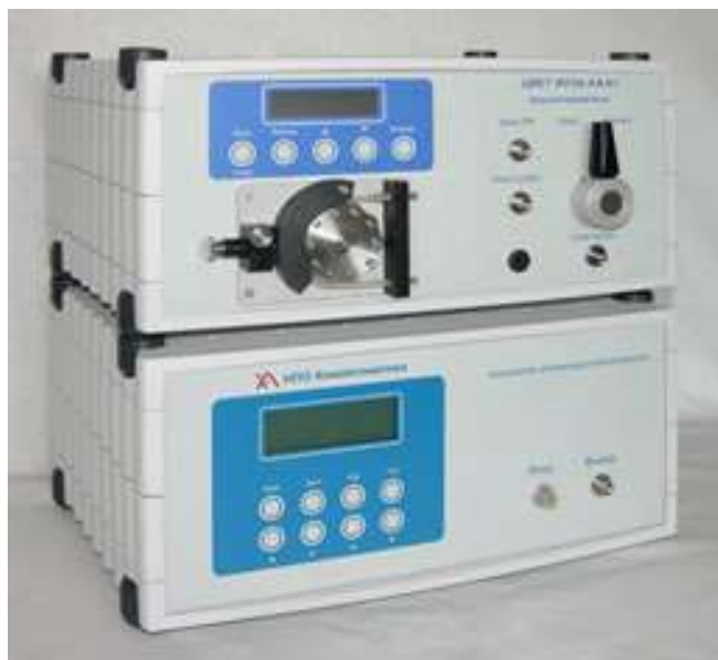
Рис. 2. Анализатор антиоксидантной активности «Цвет Яуза-01-АА»
