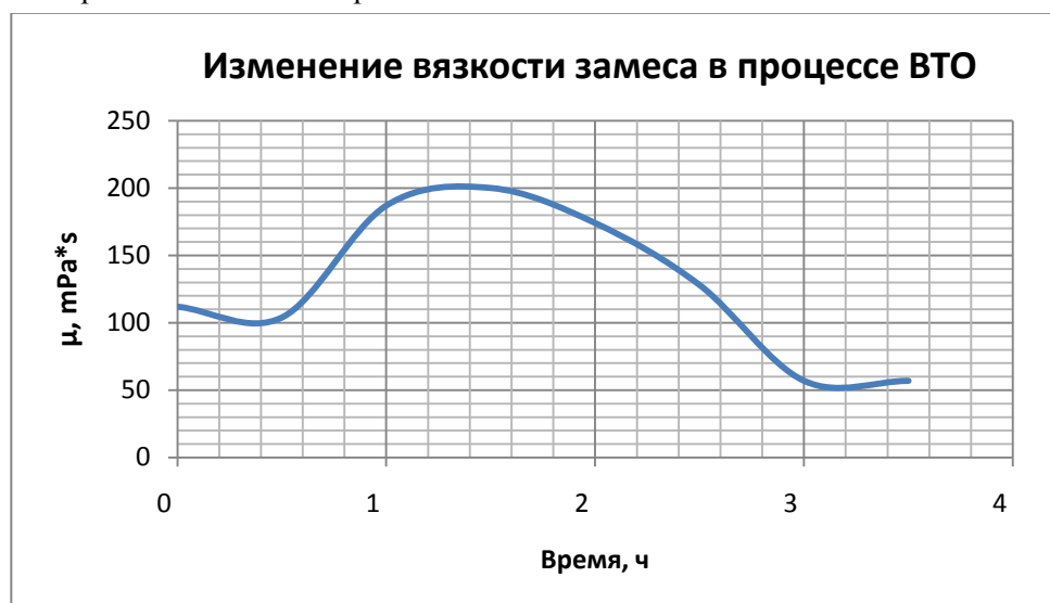
Рис. 3. Изменение коэффициента динамической вязкости \mu зернового замеса из ячменя с гидромодулем 1:2.5 в процессе водно-тепловой обработки в КСИБА (окружная скорость сдвига 100 об/мин)
