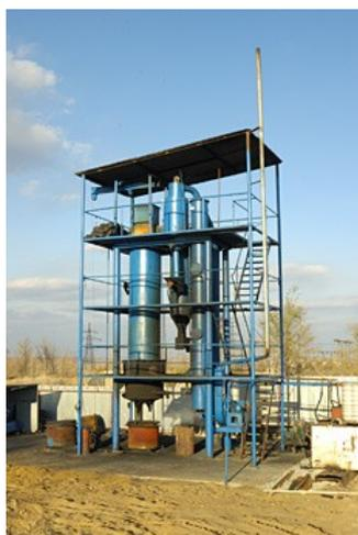
*Рис. 1. Комплекс для утилизации автомобильных шин*
