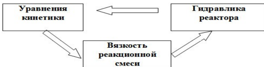
Рис. 1. Схема моделирование работы мембранного реактора
