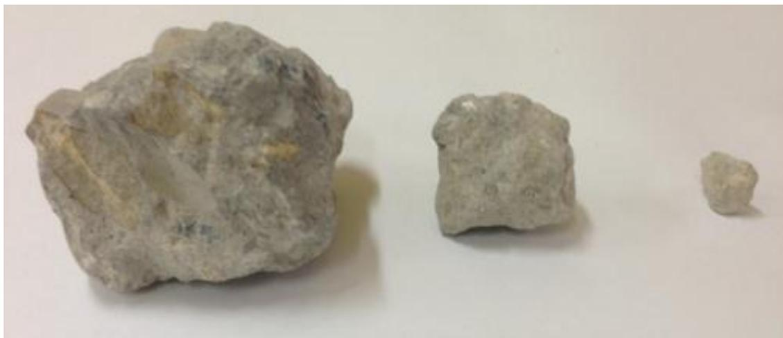
Рис 1. Зерна щебня кубовидной формы из дробленого вторичного бетона
