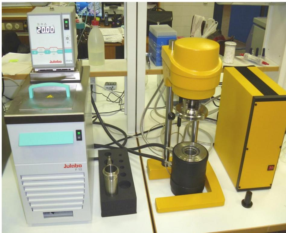
Рис. 1. Ротационный вискозиметр Rheotest-Medingen GmbH Rn4.1
