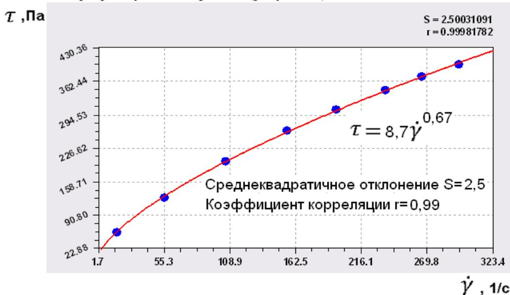
Рис. 3. Связь между скоростями сдвига и касательным напряжением на поверхности цилиндра
