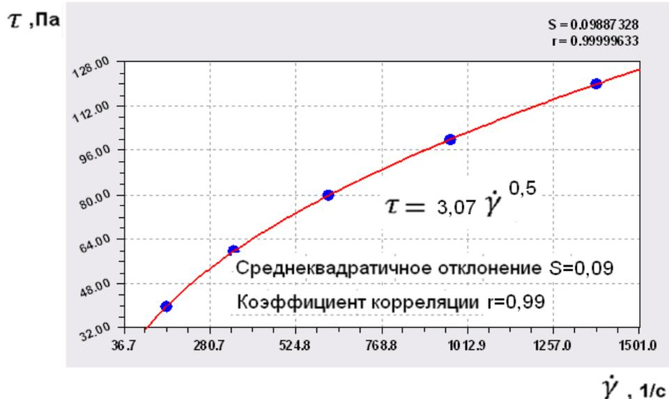
Рис. 8. График реологической кривой с установки Щербакова А.С.
